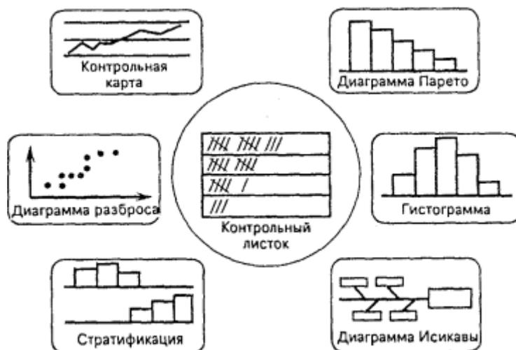
Рис. 7. Инструменты контроля качества.
