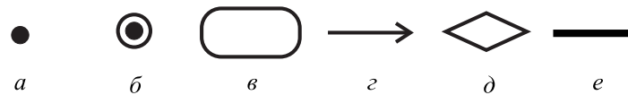
Рис. 1.10 – Элементы диаграммы деятельности: a – начальное состояние; б – конечное состояние; в – действие; г – переход; д – ветвление; e – синхронизация
