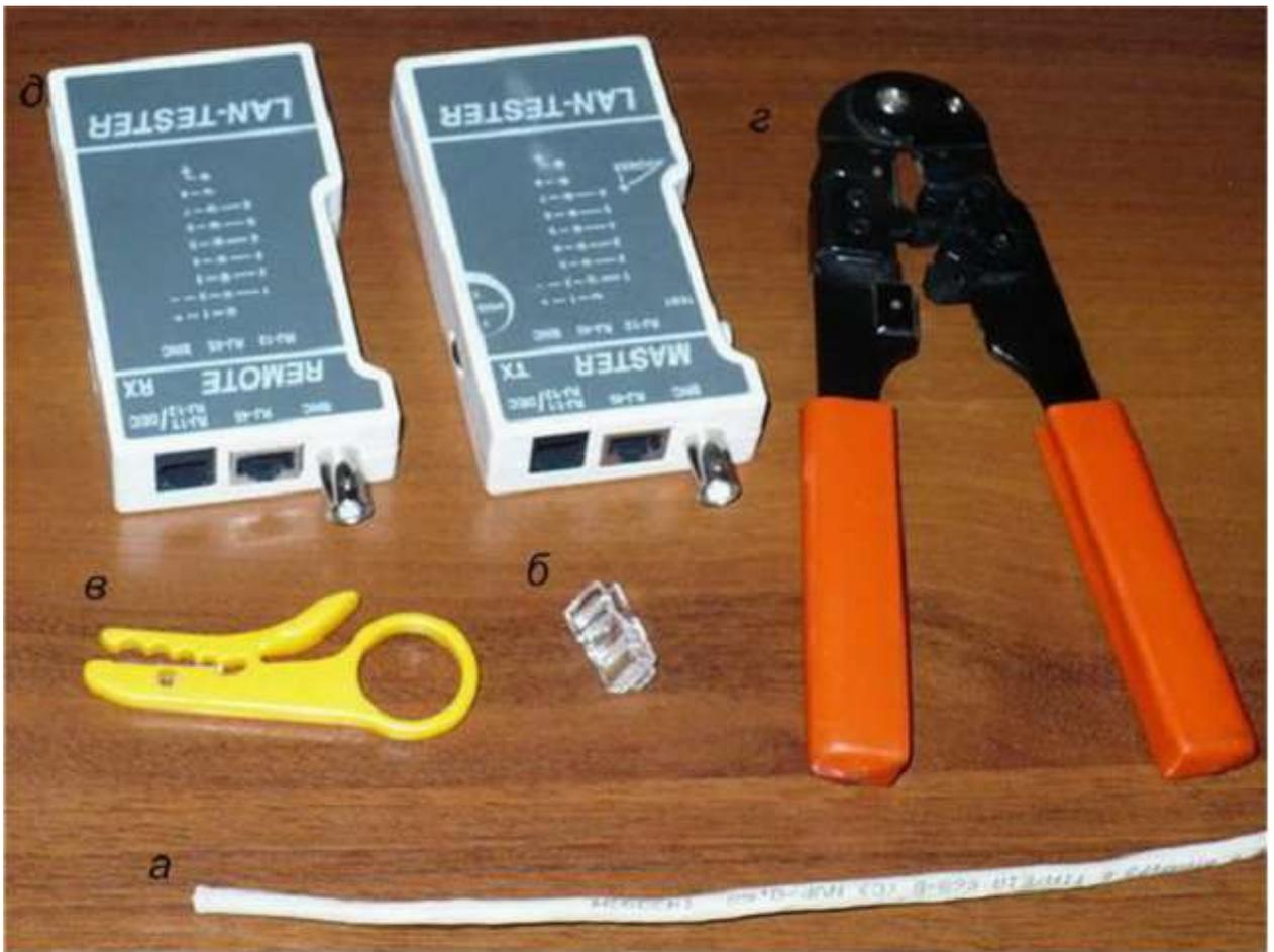
Рисунок 2.3 - Устройства для зачистки, обжима и проверки "витых пар"
