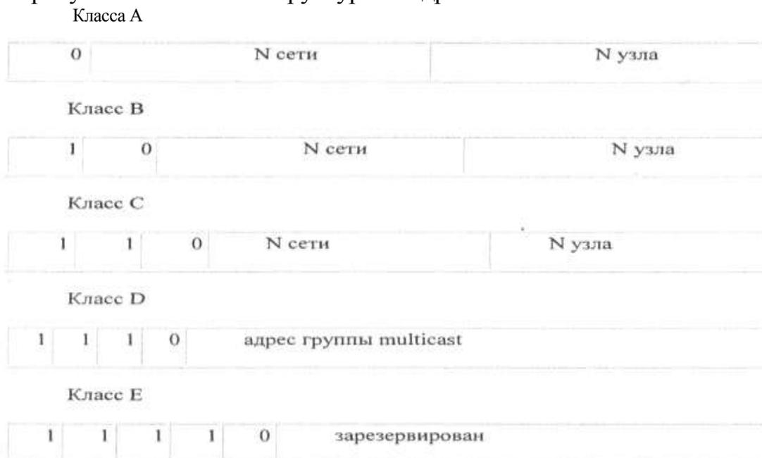
Рисунок 2.4 – Структура IP- адреса
