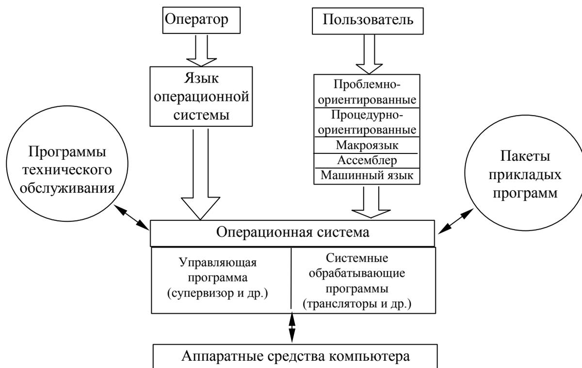
Рис. 2. 4. Структурная схема программного обеспечения персонального компьютера
