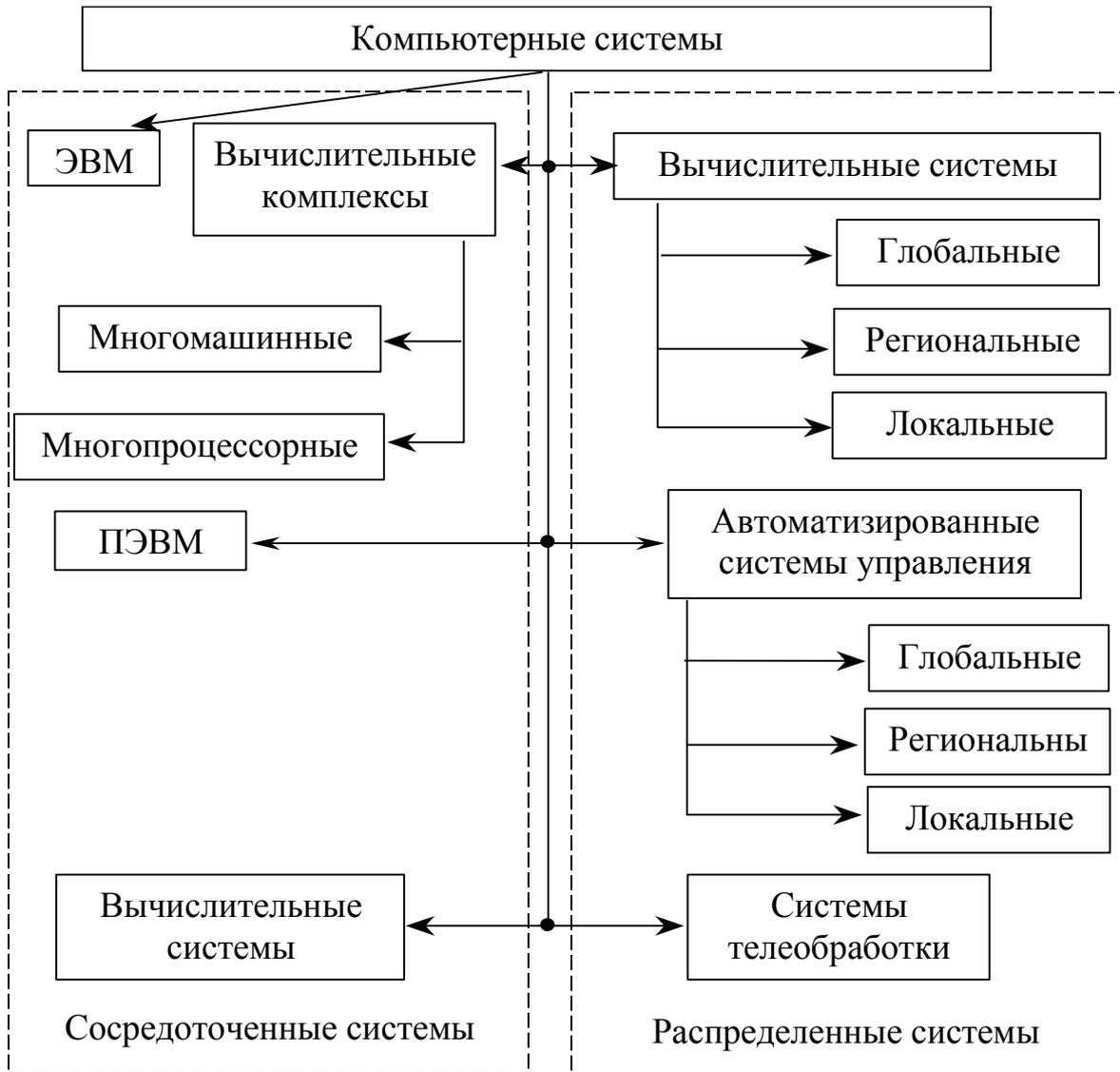
Рис. 2. 1. Классификация компьютерных систем по способу построения
