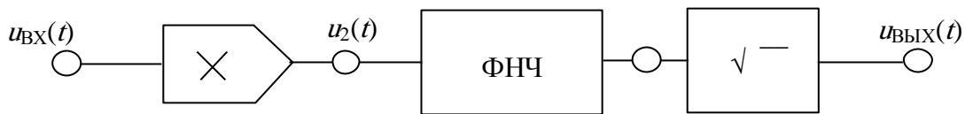
Рис. 3.32 – Структурная схема корреляционного детектора
