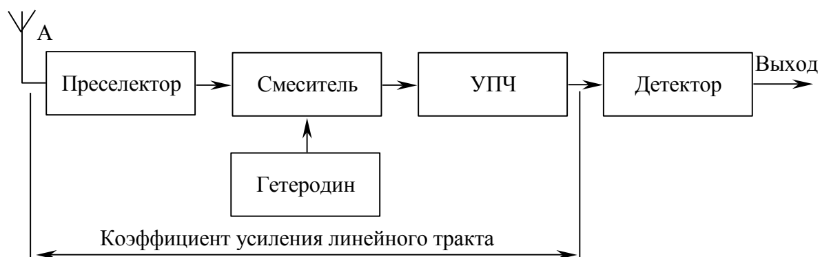
Рис. 2.6 — Структурная схема супергетеродинного радиоприемника
