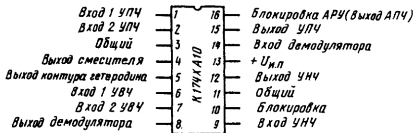
Рис. П.4.48 — Назначение выводов ИМС К174ХА10
