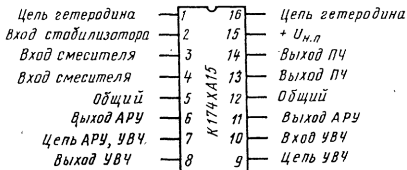
Рис. П4.51 — Назначение выводов ИМС К174ХА15
