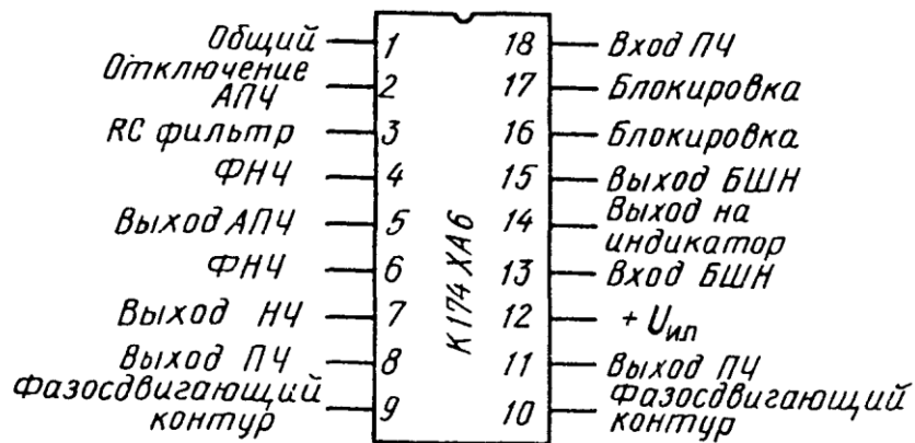
Рис. П4.42 — Назначение выводов ИМС К174ХА6
