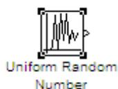
**Uniform Random Number** – источник случайного дискретного сигнала с нормальным распределением. *Назначение:* формирование случайного сигнала с равномерным распределением уровня. *Параметры блока:* **Minimum** – минимальный уровень сигнала; **Maximum** – максимальный уровень сигнала; **Initial seed** – начальное значение генератора случайного сигнала; **Sample time** – такт дискретности.
