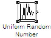
**Uniform Random Number** – источник случайного дискретного сигнала с нормальным распределением. *Назначение:* формирование случайного сигнала с равномерным распределением уровня. *Параметры блока:* **Minimum** – минимальный уровень сигнала; **Maximum** – максимальный уровень сигнала; **Initial seed** – начальное значение генератора случайного сигнала; **Sample time** – такт дискретности.
