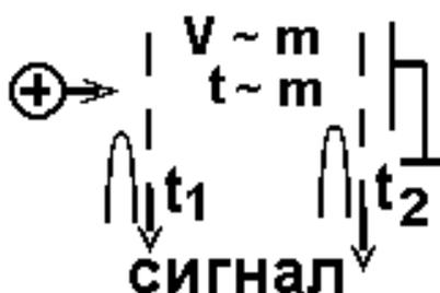
Рисунок 3.6 – Схема времяпролетного масспектрометра (хронотрона)
