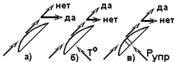
Рисунок 1.3 – а) - схема пассивного пневмоэлемента; б), в) - схемы активных пневмоэлементов
