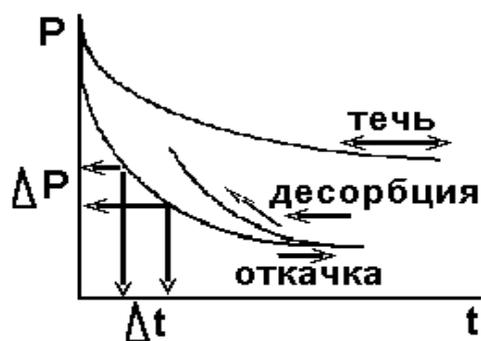
Рисунок 3.7 – Кривые откачки для анализа вакуумной системы
