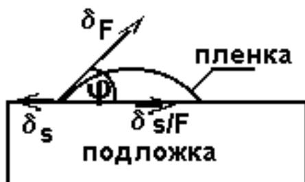
Рисунок 7.5 – Схема, поясняющая механизм формирования пленки.
