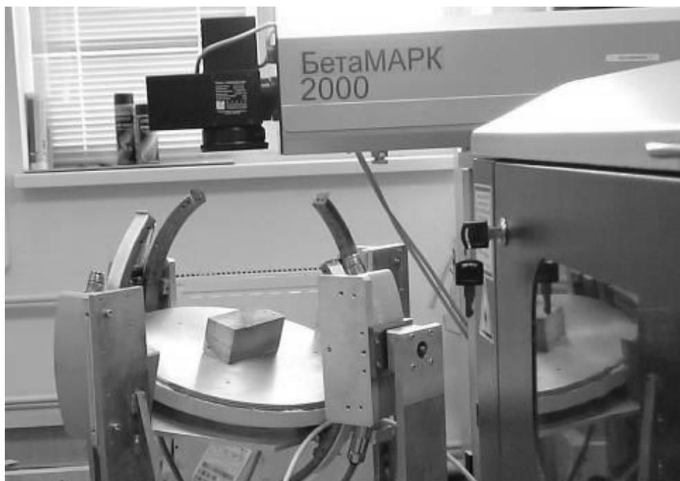
Рис. 2. Лазерный технологический комплекс с четырехкоординатным манипулятором
