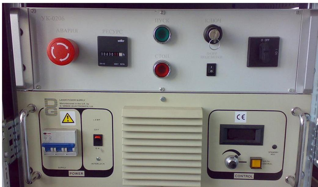
Рис. 4. Блок управления лазерной установки
