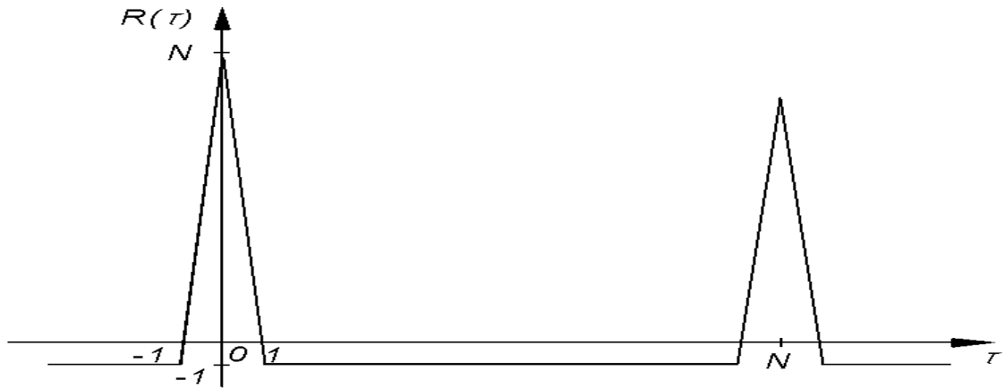
Рис.5.2 Периодическая корреляционная функция М-последовательности
