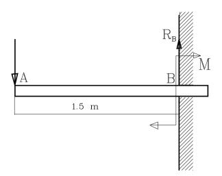
В этом случае заделка балки препятствует ее повороту вокруг точки B, поэтому реакция будет состоять не только из силы, изображенной на схеме в виде  $R_A$ , но и момента, показанного в виде пары с моментом M. Направление реакции вертикально, поскольку здесь внешние силы (в данном примере одна сила) действуют тоже вертикально.
