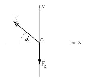
Материальная точка движется под действием двух сил  $F_1$  и  $F_2$  (в соответствии со схемой) вдоль оси Ox. Какова должна быть величина силы  $F_2$ , чтобы точка двигалась по прямой Ox?
