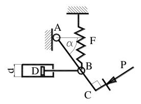
В этой задаче неизвестным является давление в гидравлическом цилиндре. Оно однозначно определится, если известна сила R, действующая на шток BD. Таким образом, в этой задаче есть всего лишь одна неизвестная величина R. Рассмотрим уравнение равновесия моментов всех сил, приложенных к рычагу AC, относительно точки A. В этом случае реакции в шарнире A не нужны, поскольку вклад их в уравнение равновесия моментов отсутствует.
