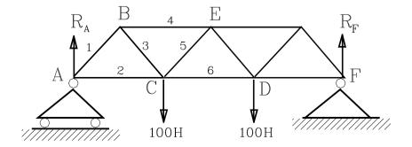
$R_A$ . Поскольку неизвестных величин только две — это усилия  $S_1$  и  $S_2$  в стержнях 1 и 2 — можно начинать расчет с этого стержня. С учетом того, что усилия в стержнях направлены от узла A, проектируем все величины на ось х (горизонтальную) и ось у — вертикальную. Получим два уравнения:
