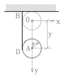
Круглый цилиндр обмотан тонкой нитью, конец которой неподвижно закреплен в точке В. Цилиндр падает без начальной скорости, разматывая нить, скорость оси цилиндра определяется зависимостью
