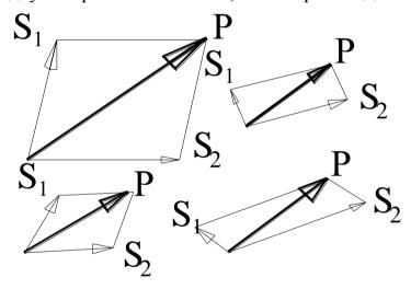
На рисунке приведены примеры разложения вектора P вдоль двух произвольных (непараллельных) направлений на составляющие  $S_1$  и  $S_2$ .
