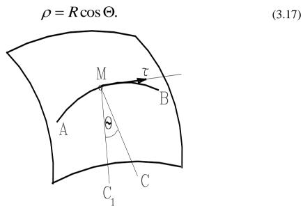
Здесь угол  $\Theta$  образован соприкасающейся плоскостью траектории движения точки и нормалью к поверхности. Если спроектируем направление главной нормали  $MC_1$  на плоскость, касательную к поверхности в точке M, получим прямую Mb, которая определит направление бинормали.
