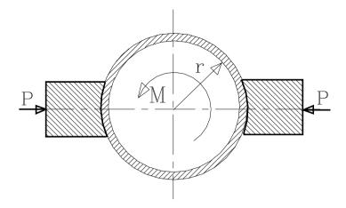
Для равновесия необходимо, чтобы сумма моментов, приложенных к барабану, равнялась нулю. Силы трения F – из-за симметрии – образуют пару, момент которой можно определить как 2\*F\*r, причем сила трения определяется через прижимающую силе P по формуле для сил трения скольжения
