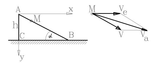
направлена вправо, ось Ay — вниз. Движение точки M по отношению к призме принимаем за относительное, а движение самой призмы по полу — за переносное. Строим параллелограмм скоростей, диагональ которого  $v_a$  и будет искомой скоростью. Проектируем составляющие абсолютной скорости на оси неподвижной системы координат:
