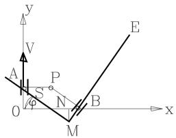
образованного стержнем AM с осью Ox, скорость точки стержня ME, которая в данный момент совпадает с точкой B. Считая, что в начальный момент времени точка A совпадает с точкой O и скорость точки A постоянна, определить уравнение движения прямого угла AME.
