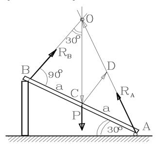
сила тяжести балки проходит через ее середину вертикально, а реакция выступа стены действует по нормали к балке, так как трением пренебрегаем. По теореме о трех силах линия действия третьей силы – реакции шарнира — должна проходить через ту же точку О, где пересекаются линии действия двух известных сил. В силу равновесия системы силовой треугольник должен быть замкнут. Направления же всех сил известны, поэтому силовой треугольник подобен геометрическому треугольнику СОО. Из этого подобия следует
