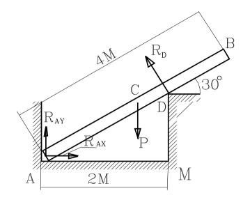
В этом примере заданной внешней силой является только вес балки P, приложенный в середине балки, в точке C. Реакция в точке D направлена по нормали к балке. Что касается реакции в точке A, ее направление заранее неизвестно, и поэтому на схеме рисуем составляющие  $R_{AX}$ ,  $R_{AY}$ .
