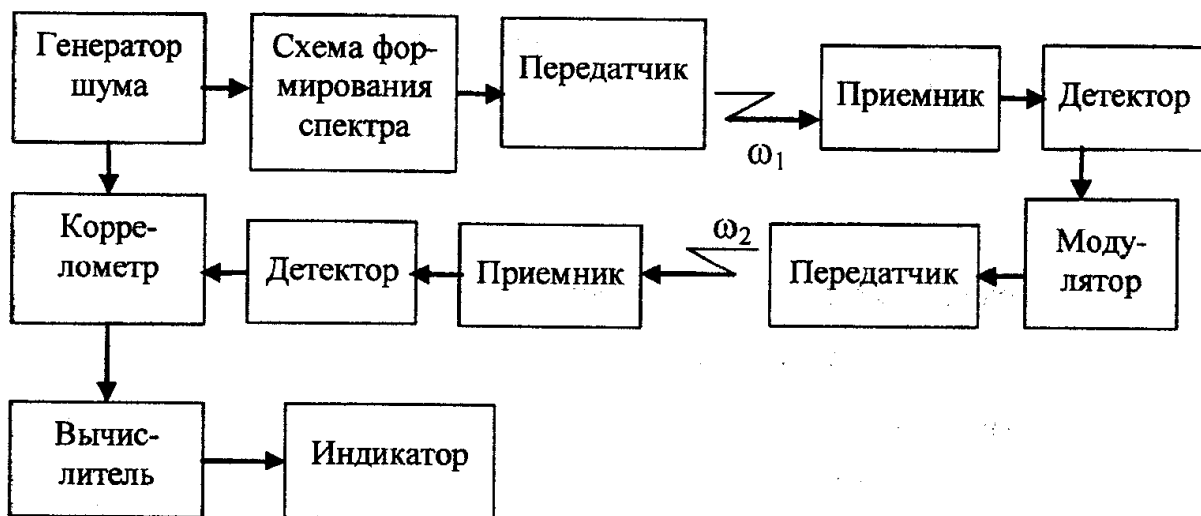
Рис. 5.3. Схема дальномера с широкополосным сигналом
