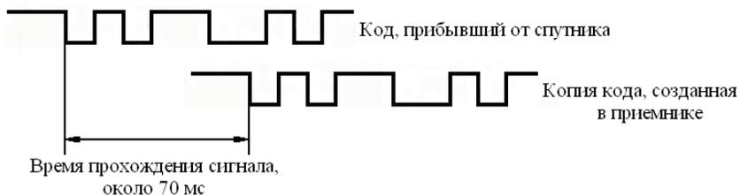
Рис. 3. Однонаправленное измерение расстояния с использованием PRN-кодов
