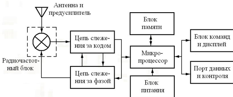
Рис. 1. Основные компоненты, общие для одноканальных GPS приемников
