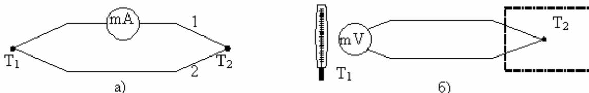
Рисунок 3.3. Схема подключения термопары а) при измерении тока в цепи; б) при измерении напряжения в цепи
