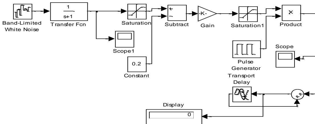
Рисунок 2.2 Структурная схема модели устройства для измерения функции распределения случайного процесса.
