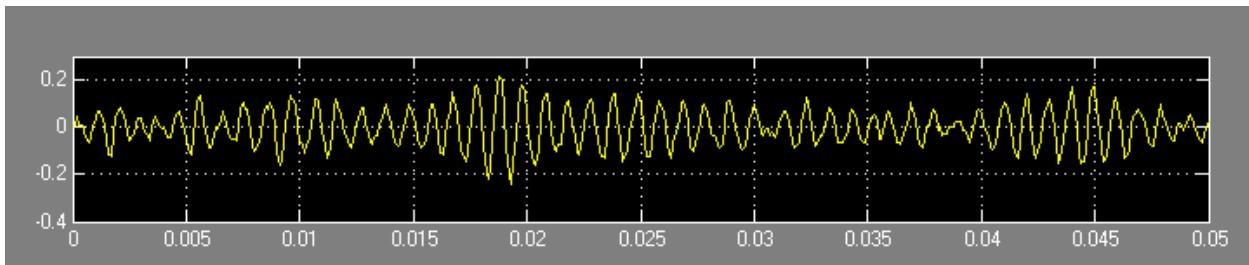
Рисунок 3.2 Реализация узкополосного случайного процесса,
