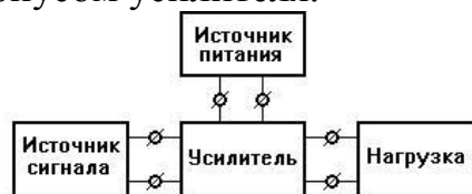
Рисунок 7.7 Усилители электрических колебаний могут усиливать колебания по напряжению, по току, по мощности.
