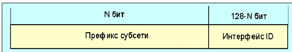
Рис.37 Структура адреса IPv6
