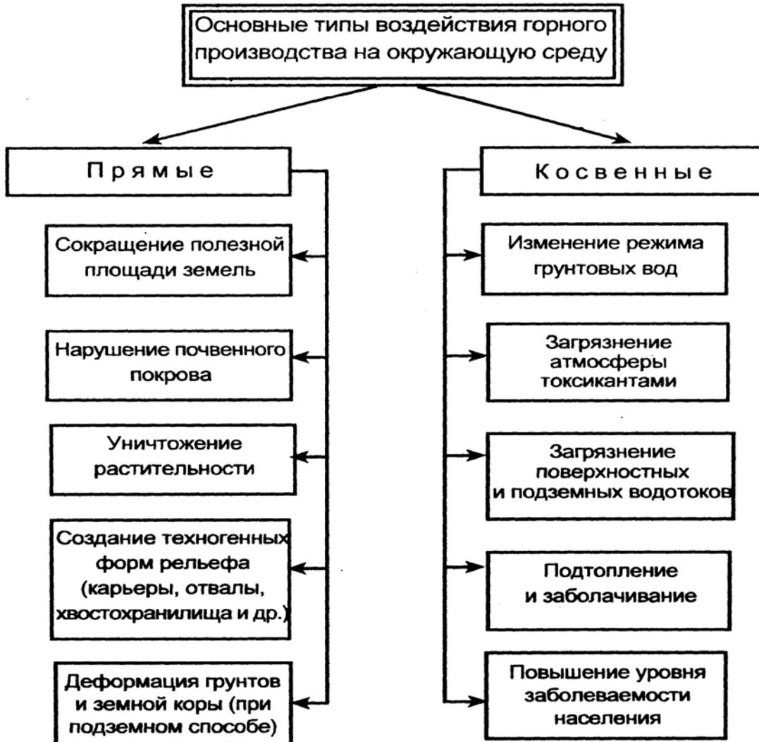
Рис. 9.4. Основные типы воздействий горного производства на окружающую среду
