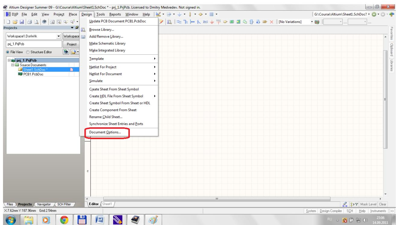
Для создания компонента в первую очередь требуется изобразить условно-графическое обозначение (УГО) элемента схемы. Правила создания УГО элементов аналоговой и цифровой техники регламентируются ГОСТ 2.759-82 и 2.743-91 соответственно. Кроме этого, размещаются электрические контакты в узлах сетки. Эти контакты служат для взаимного
