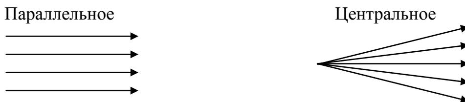
При этом первый способ проектирования можно рассматривать как предельный случай второго способа при удалении центра проектирования на бесконечность.
