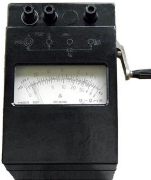
Рисунок 2.1 – Мегаомметр М4100
