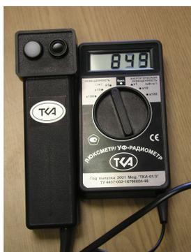
Цифровой фотометр модель «ТКА-09» предназначен для измерения освещенности (Лк) и яркости протяженных самосветящихся объектов (кд/м<sup>2</sup>) в видимой области спектра.
