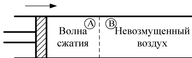
Рис. 3.14. Вдвигание поршня в цилиндр
