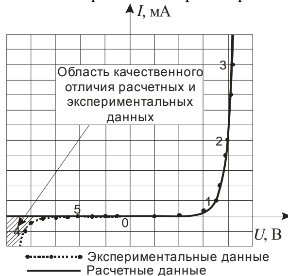
Рис. 1. Вольтамперная характеристика светоизлучающего диода
