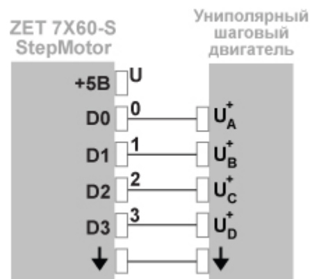
Рис. 6 Схема подключения униполярного Ш.Д.
