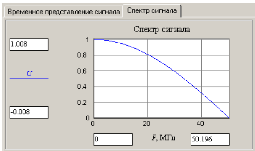
Рисунок 7.6 – График амплитудного спектра синтезированного тестового сигнала
