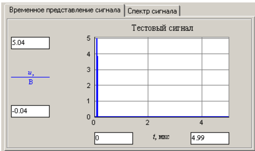
Рисунок 7.5 – График временной формы синтезированного тестового сигнала
