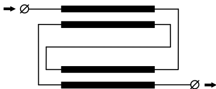
Рис. 9.19. Фазовый корректор на основе двух отрезков связанных линий
