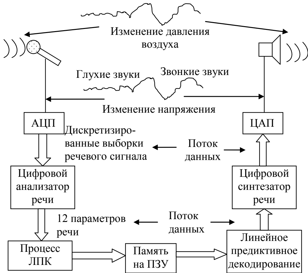
Рисунок 6.11 — Принцип линейного предиктивного кодирования
