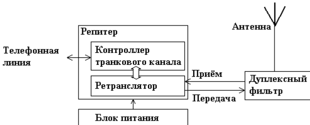
Рисунок 5.28 — Структурная схема базовой станции
