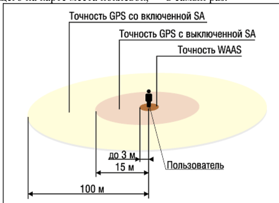
Рисунок 5.24 — Точность GPS в различных режимах
