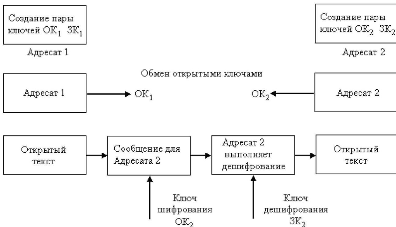
Рисунок 2.2 - Процесс шифрования с открытым ключом
