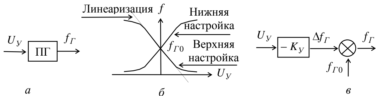
Рис. 3.12. Подстраиваемый генератор: а — функциональная схема; б — регулировочная характеристика (верхняя настройка: f_{\Gamma} > f_{\Gamma 0} и K_{\nu} K_{\text{чд}} < 0 ; нижняя настройка: f_{\Gamma} < f_{\Gamma 0} и K_{\nu} K_{\text{чд}} > 0 ), в — структурная схема
