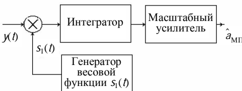
Рис. 4.6. Структура оптимального измерителя амплитуды полностью известного радиоимпульса
