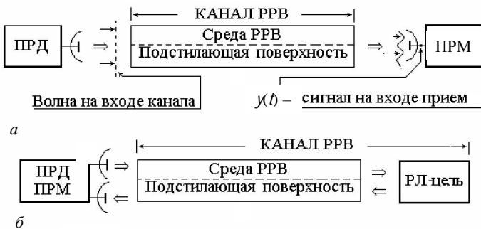
Рис. 2.1. Структура типичных радиоканалов для РТС передачи информации (а); для измерительных РТС (б): ПРД — передатчик; ПРМ — приемник
