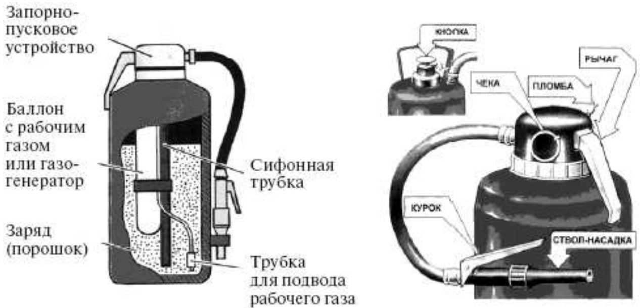
Рис. 3. Порошковый огнетушитель со встроенным газовым источником давления ОП-5
