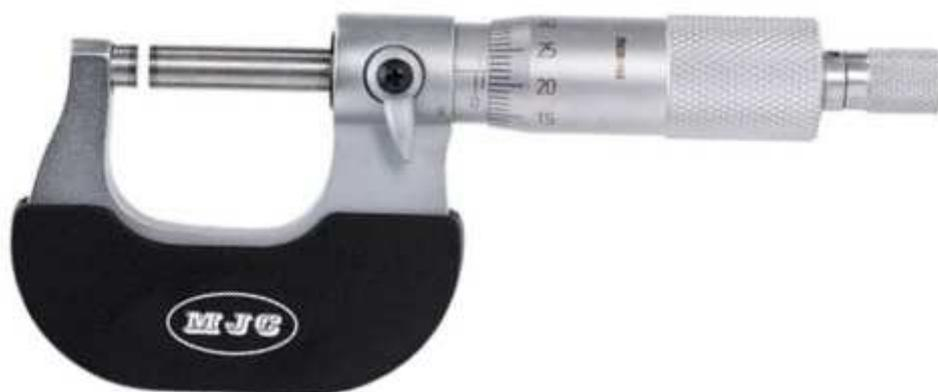
Рисунок 3.2 – Микрометр
