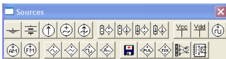
Рис. 4. Панель элементов Sources.
