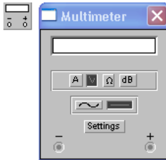
Рис. 20. Две формы отображения прибора Multimeter в программе EWB.
