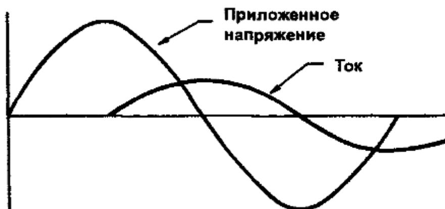
Рис. 23. Переменное напряжение и ток на катушке индуктивности
