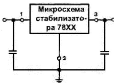
Рис. 61. Схема включения стабилизатора в интегральном исполнении
