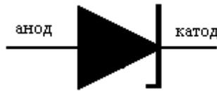
Рис. 50. Условное обозначение стабилитрона
