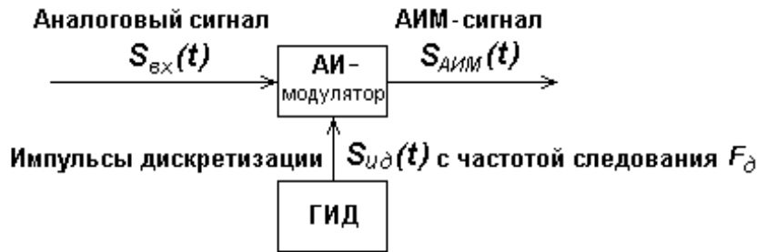
Рисунок 1 - Структурная схема устройства для дискретизации аналогового сигнала; ГИД - генератор импульсов дискретизации
