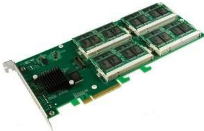
Рис. 2.28 - Твердотельный накопитель 1 TB SSD Z-Drive. Средняя скорость чтения/записи до 800 МБ/с. Вес – 500 г. Стоимость ~ 100 000 руб.
