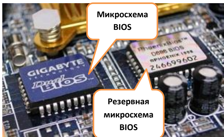
Рис. 1.22 – На материнской плате нередко устанавливают 2 микросхемы BIOS (технология DualBIOS ), и, в случае внештатной ситуации (последствия вируса или неудачной прошивкой новой версии), есть возможность восстановить испорченный BIOS .
