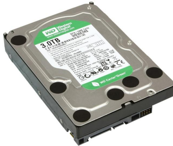
Рис. 2.24 - Накопитель на жестких магнитных дисках (НЖМД) Western Digital Caviar Green емкостью 3 Тб
