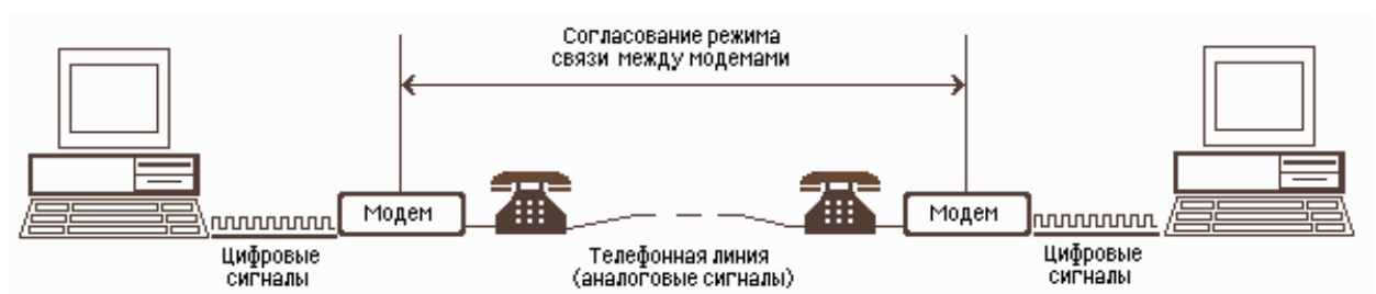
Рис. 2.34 - Принцип обмена информацией между удаленными компьютерами по каналам связи,
