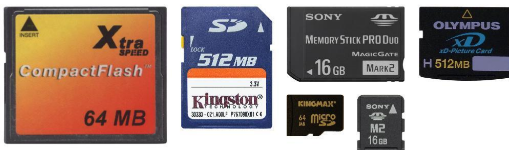
Рис. 2.30 - Сравнение размеров различных стандартов карт памяти
