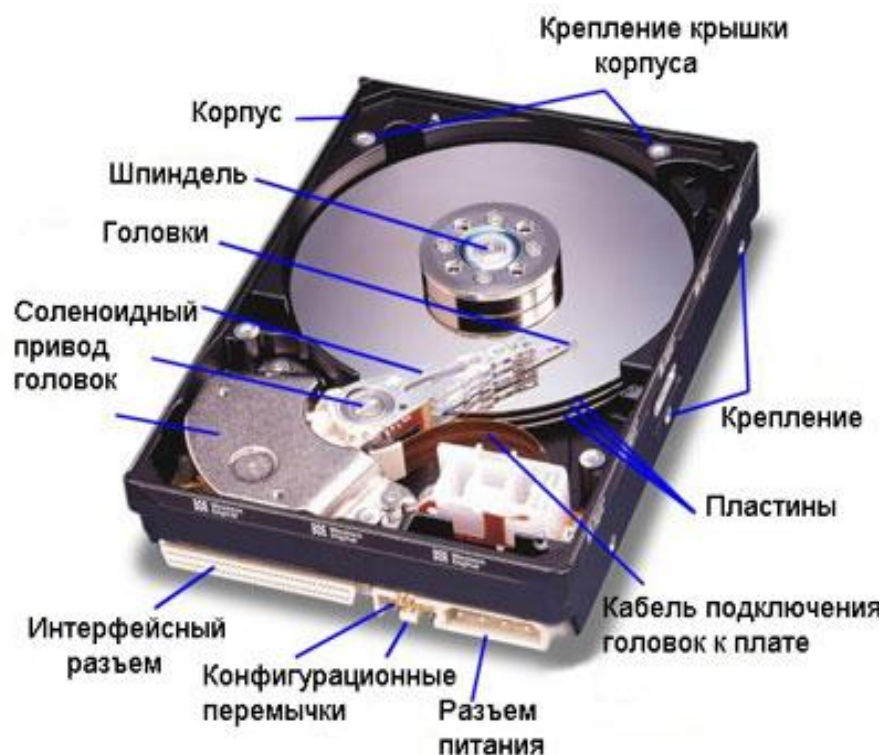
Рис. 2.22 – Устройство накопителя на жестких магнитных дисках
