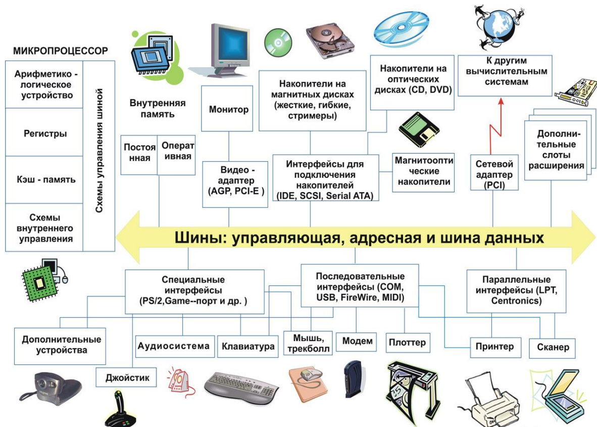
Рис. 1.8 - Для взаимодействия всех блоков компьютера между собой и с центральным процессором организуется приемно-передающий канал - системная шина
