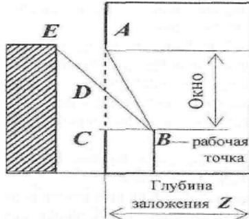
Рисунок 4.1 - Схема для определения основных характеристик освещенности (характерный разрез помещения)
