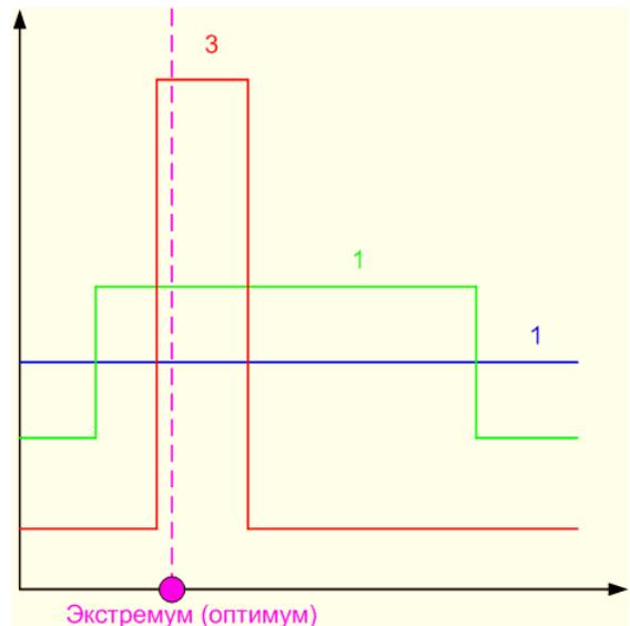
Рис. 5.18 - Иллюстрация изменения плотности распределения вероятности для алгоритма случайного поиска (одномерный случай)
