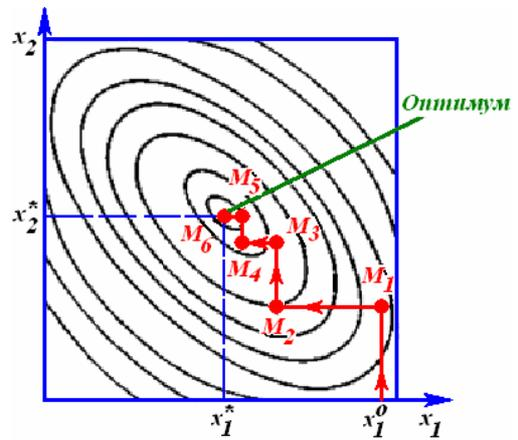
Рис. 5.13 - Поиск оптимума целевой функции методом покоординатного спуска
