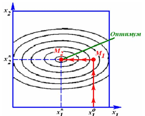
Рис. 5.14 - Линии уровня целевой функции по форме близки к окружностям или эллипсам, оси которых параллельны осям координат
