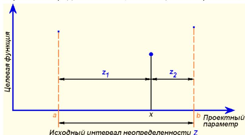
Рис. 5.10 - Обозначения, используемые в методе золотого сечения
