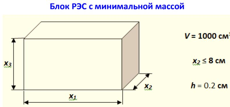
Рис. 6.1 - Оптимизация размеров блока РЭС
