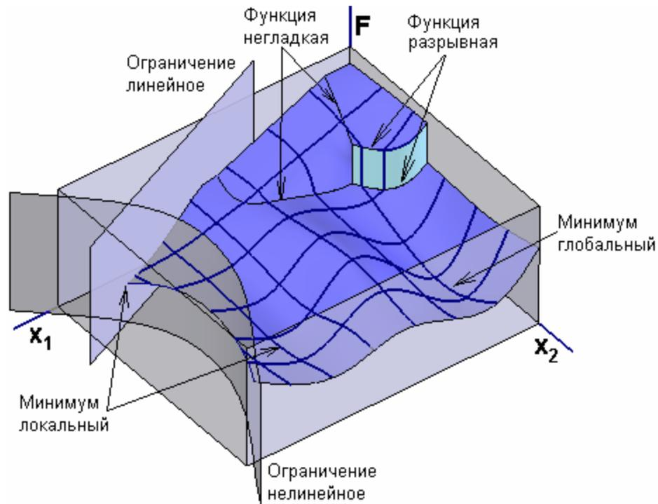
Рис. 5.2 – Поверхность отклика двумерной целевой функции
