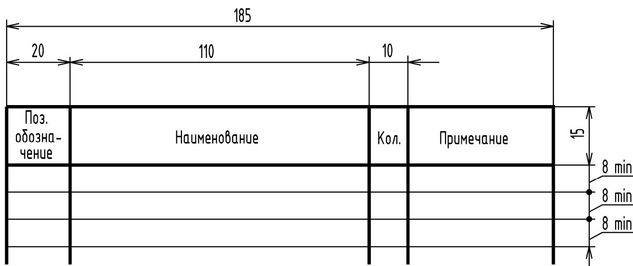
Рис. 7. Верхняя часть таблицы перечня элементов с размерами.
