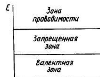
Рис. 2.2. Простая модель энергетических зон
