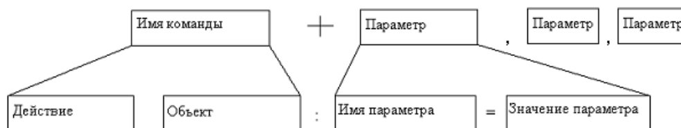
Рис.4 Структура расширенного формата команды с несколькими параметрами
