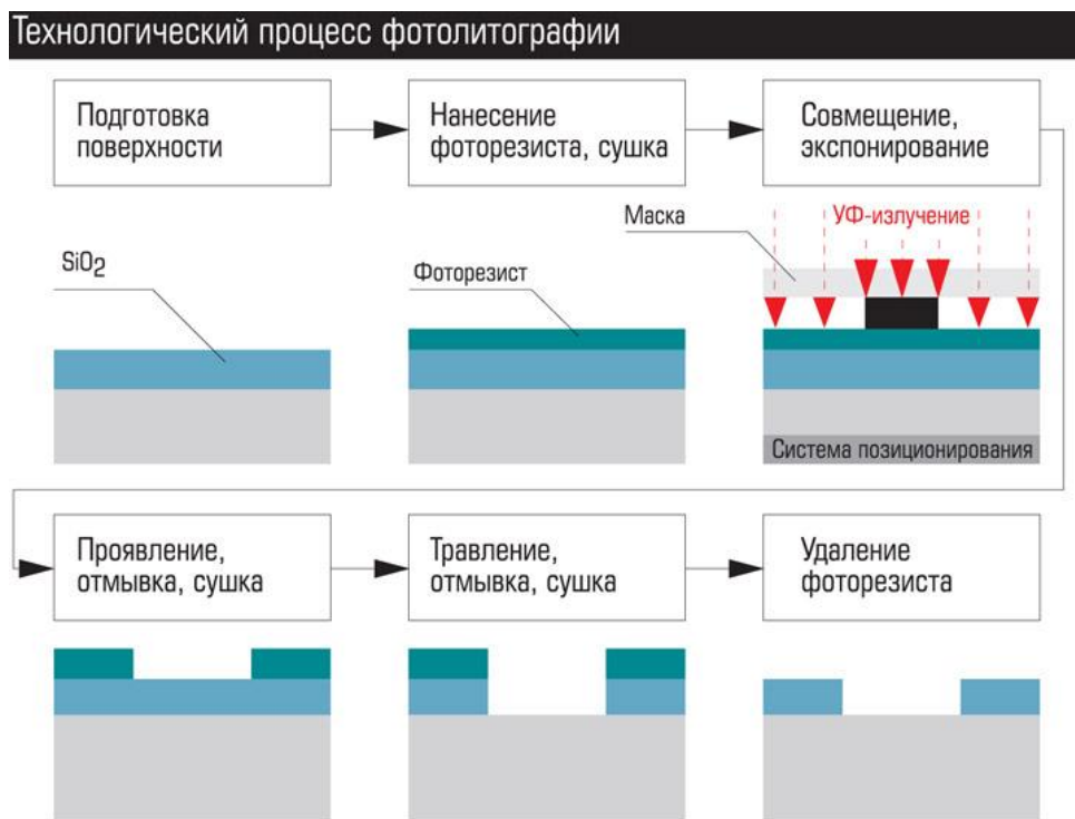
Рисунок 15.4 – Технологический процесс фотолитография
