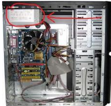
Рисунок 1.5 – Красным выделен блок питания.
