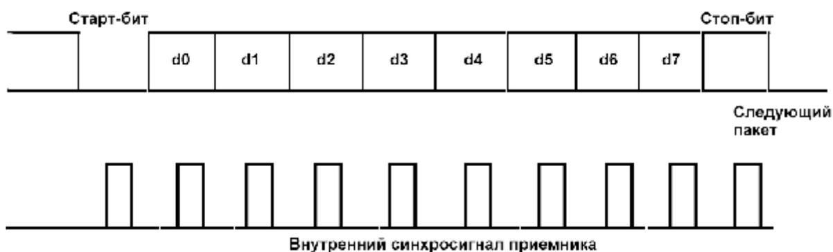
Рис. 16. Сигнал RXD и внутренний синхросигнал приемника
