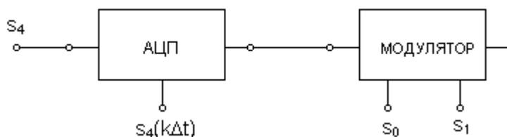
Рис. 3. Преобразование аналогового сигнала в цифровой модулированный сигнал
