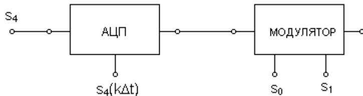
Рис. 3. Преобразование аналогового сигнала
