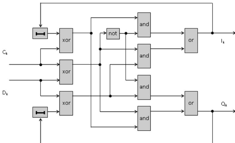
Рисунок 2.5 - Схема преобразователя кода «абсолютный-относительный» (ПКАО).
