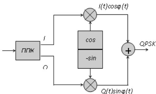
Рисунок 2.2 — Структурная схема QPSK модулятора
