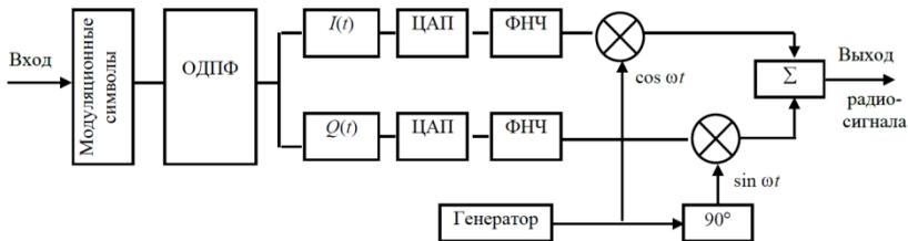
Рисунок 3.2 — Структурная схема модулятора OFDM символа
