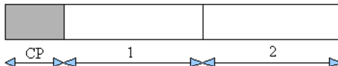
Рис. 2.17 – Пример структуры обучающего OFDM символа
