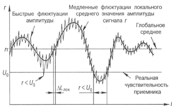
Рис. 2.24 - Быстрые и медленные замирания сигнала в многолучевом канале
