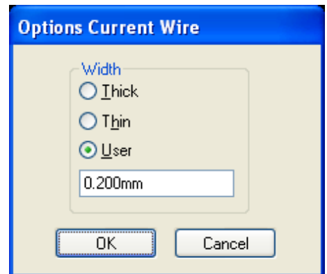
Рисунок 4.6 - Установка текущей ширины проводника
