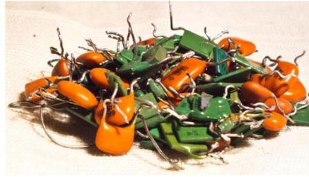
Рис. 5.75 - Конденсаторы типа КМ-6
