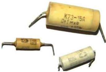
Рис. 5.63 – Конденсаторы серии К73-15
