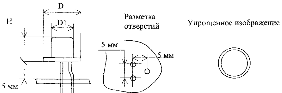
Рисунок 4.8 – Вариант установки транзисторов VT1 (КТ3102А) и VT2 (КТ342Б)
